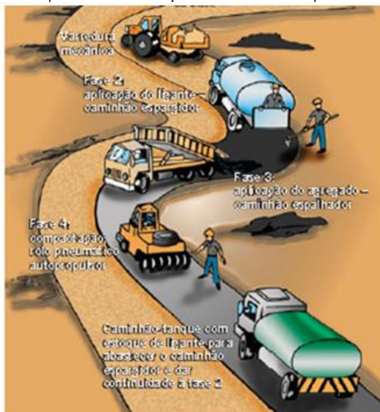
Figura 33 - Sequência esquemática de construção de um tratamento superficial
