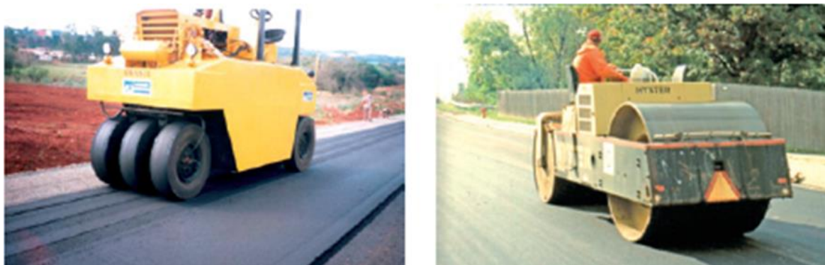
Figura 25 - Exemplos de rolo de pneus e rolo tandem liso
