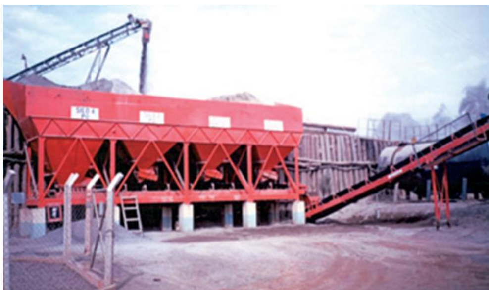
Figura 7 - Exemplo de sistema de silos frios
