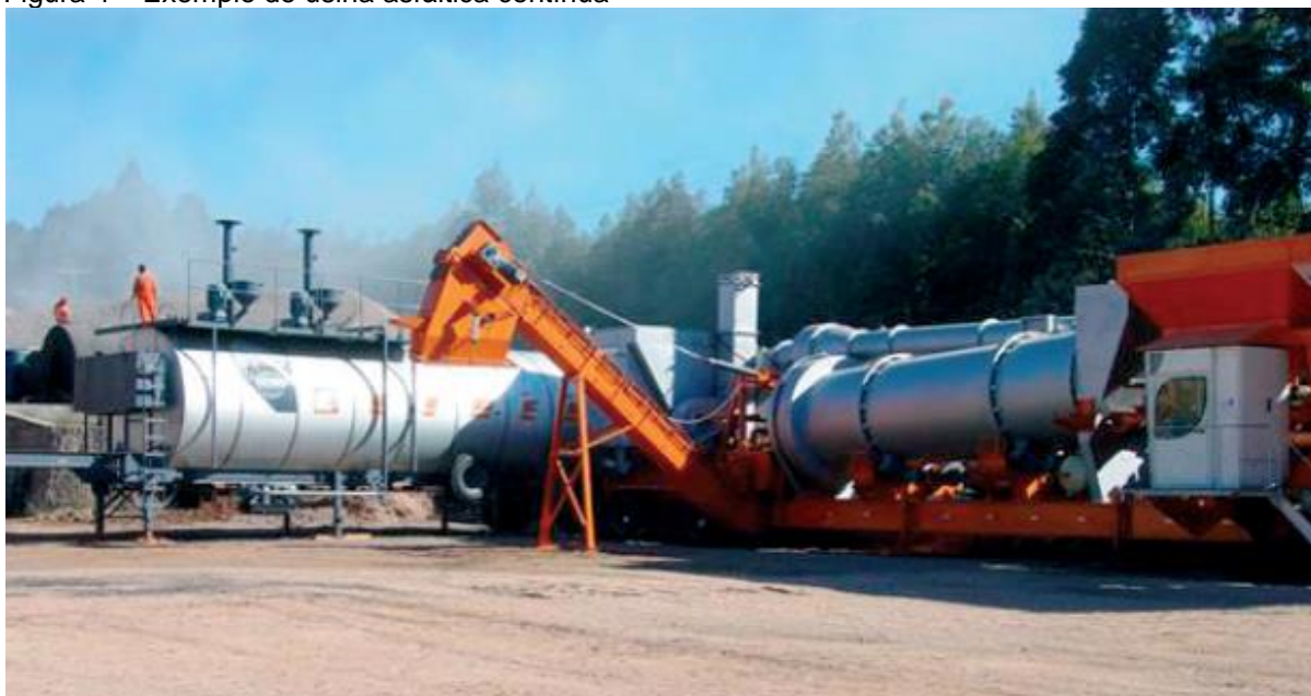
Figura 4 – Exemplo de usina asfáltica contínua
