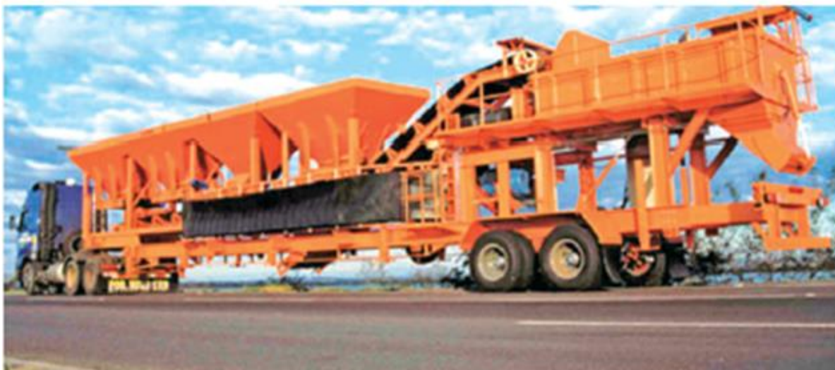
Figura 20 - Exemplo de usina de pré-misturado a frio móvel
