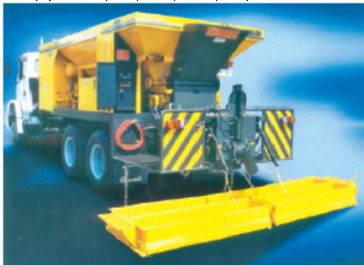
Figura 35 - Exemplo de equipamento para produção e aplicação de lama asfáltica
