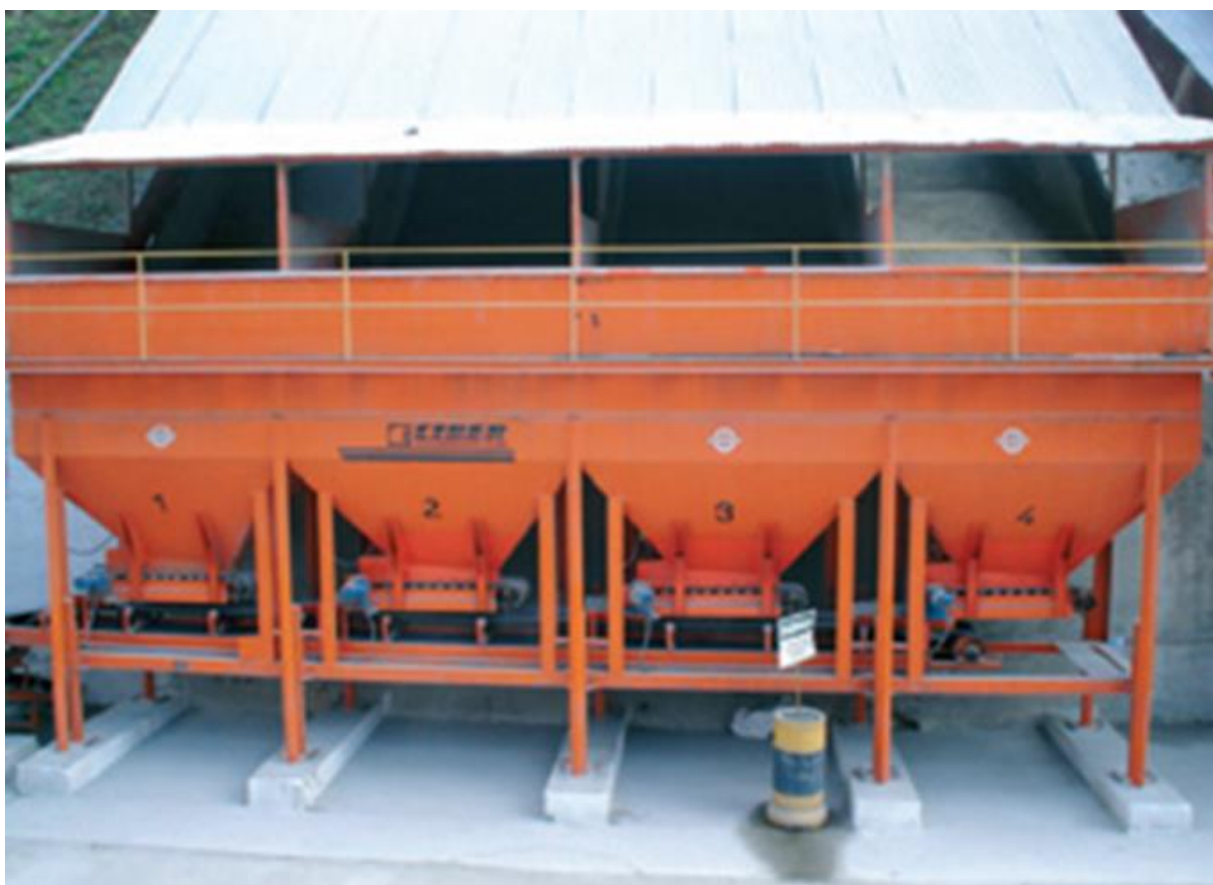
Figura 5 – Exemplo de estoques e silos cobertos para proteção dos materiais de uma usina
