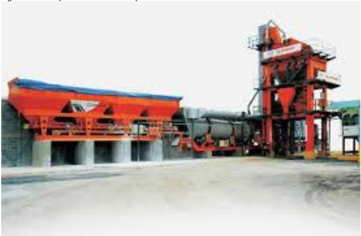
Figura 3 – Exemplo de usina asfáltica por batelada
