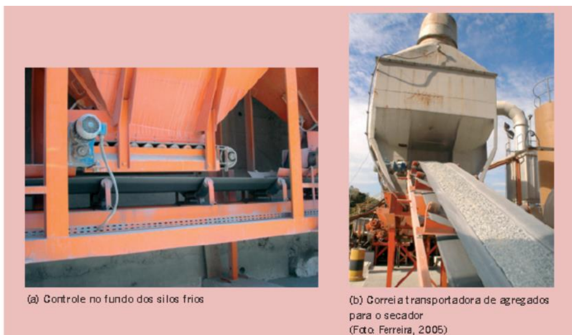
Figura 8: Exemplo de controle de alimentação de agregados de um silo frio e correia transportadora de agregados para o secador
