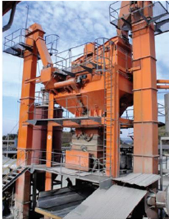
Figura 15 - Exemplo de um elevador de agregados aquecidos e silos quentes
