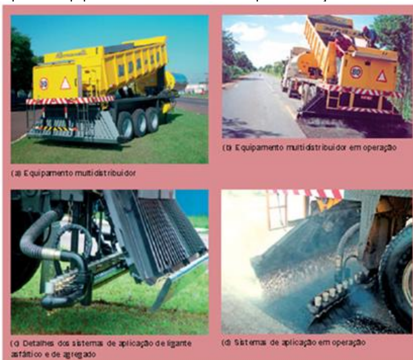
Figura 32 - Exemplos de equipamentos multidistribuidores para execução de tratamentos superficiais
