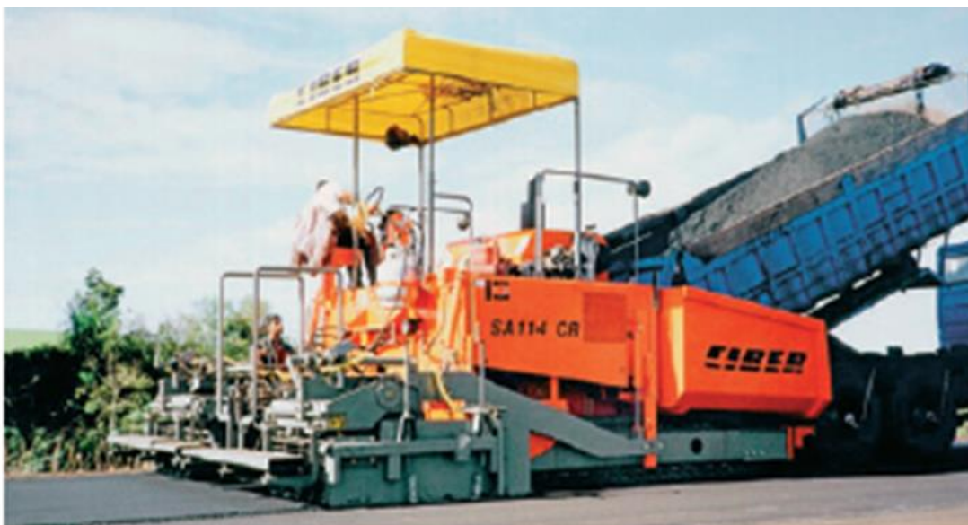
Figura 23 - Exemplo de um tipo de vibroacabadora
